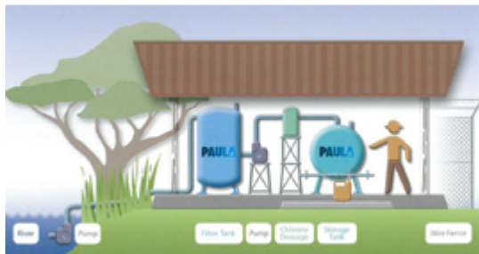
Die Wasseraufbereitungsanlage PAULA
